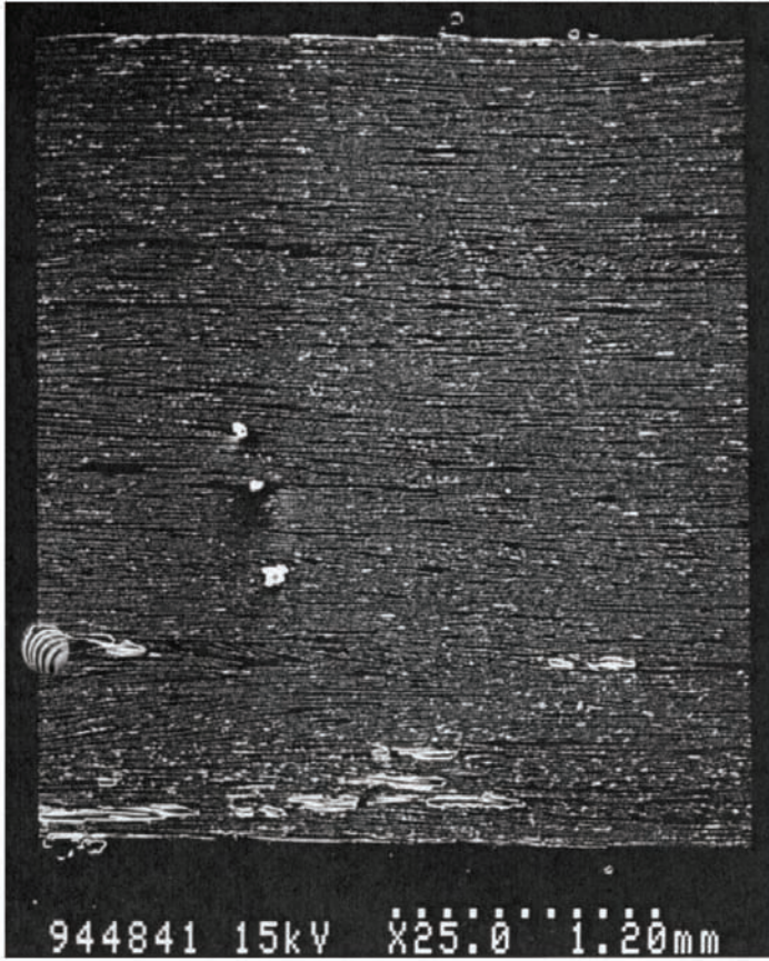
Resim 1. Taramalı elektron mikroskopu altında GFRP çubuğun boyuna ve ara kesiti.
